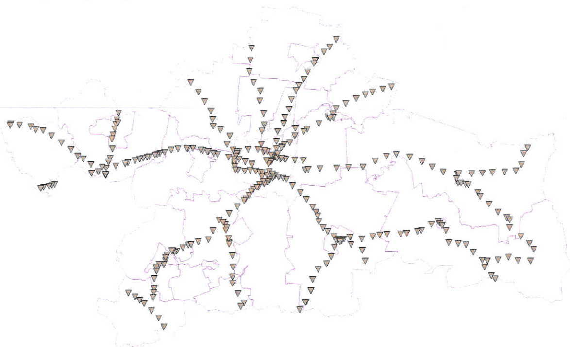
Rys. 1 – Szkic położenia reperów I i II klasy wykorzystanych przy wyznaczaniu parametrów transformacji wysokości. Numery, rzędne i współrzędne znajdują się w tabelach w dalszej części opracowania
